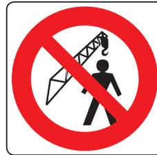
Vietato passare e sostare nel raggio d'azione della gru
