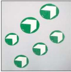
Marcatura fotoluminescente alta intensità per pavimentazione realizzata in alluminio. Adesivizzata con collante 3M, fustellata rotonda e rivestita da un trattamento antistruciolo sulla superficie. Disponibile: diametro mm 95 e mm 125.
